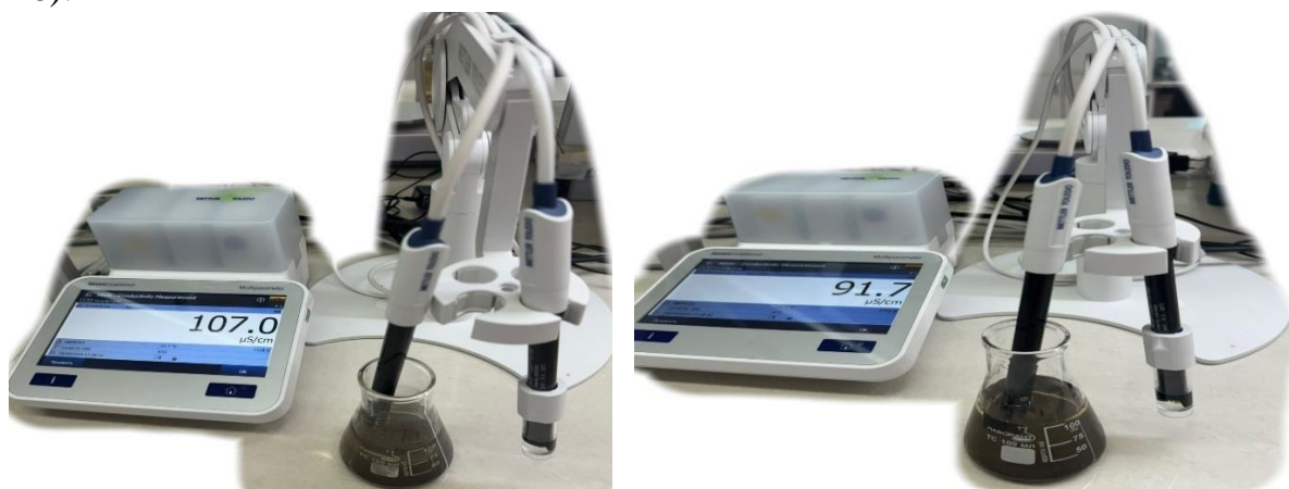
Сурет – 16 Таза топырақ электр өткізгіштігі 107 \mu\text{S}/\text{cm} және Лас топырақ электр өткізгіштігі 91.7 \mu\text{S}/\text{cm}
